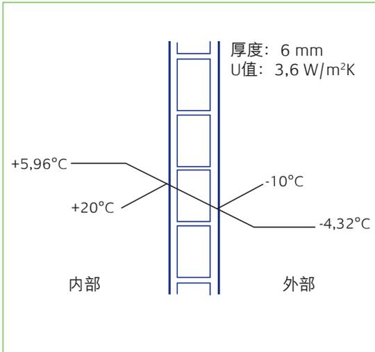
多层结构结构会创造一层空隙，从而使板材表面温度更加适中。在所示的条件下，板材内表面温度远高于零度，因此不会对建筑物内部产生冷辐射。
