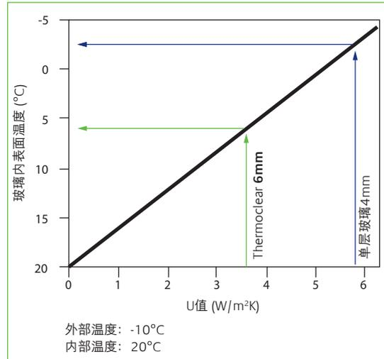
9. 在室外低温条件下，通过Lexan Thermoclear板材的温度变化过程。
