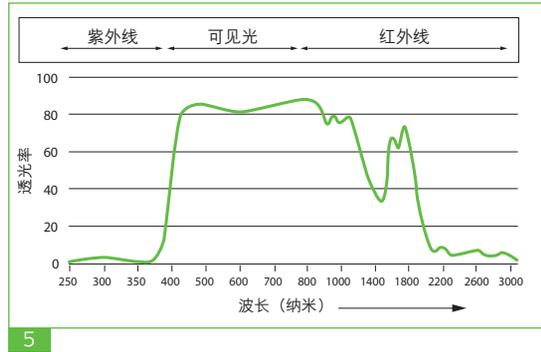
5. Lexan Thermoclear 板材的太阳光透过光谱
