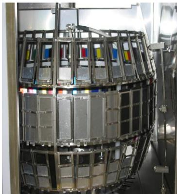
温度周期试验及加速老化试验
